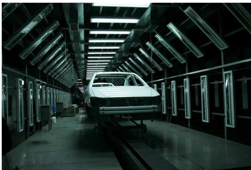
Линии катафореза и окраски на заводе полностью автоматизированы
